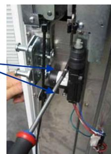
Clipper le connecteur du moteur au faisceau de câblage. Attention au sens de clippage car il y a un détrompage.
