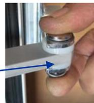
Remettre l'axe de l'arrêt de porte et clipper la rondelle.
