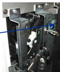
Mettre les 4 vis avec un tournevis cruciforme en serrant à 1.1 Nm.
