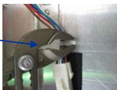
Déclipper les deux connecteurs en appuyant sur la languette.
