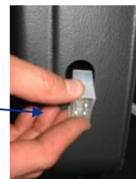
Faites passer le connecteur du faisceau à travers la peau intérieure, vous pouvez maintenant retirer totalement cette peau intérieure.
