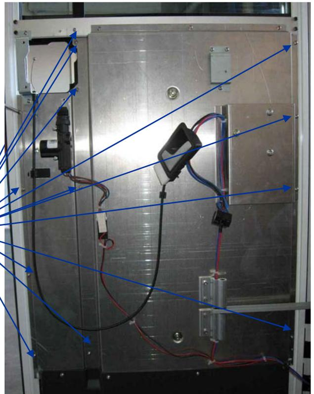
Dévisser les 4 vis maintenant la traverse verticale avec le tournevis cruciforme.
