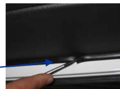
Commencer par déclipper la garniture intérieure en haut à gauche, puis descendre vers le bas de la porte du même côté jusqu'à ce que la garniture soit totalement déclipée du côté gauche.
