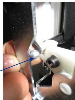
Appuyer légèrement sur la pièce plastique blanche pour avoir accès au clip de la tringle verrou afin de le déclipper à l'aide du tournevis plat.
