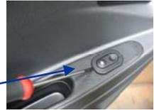
Débrancher le bouton lève-vitre du connecteur, puis insérer ce connecteur dans son logement.
