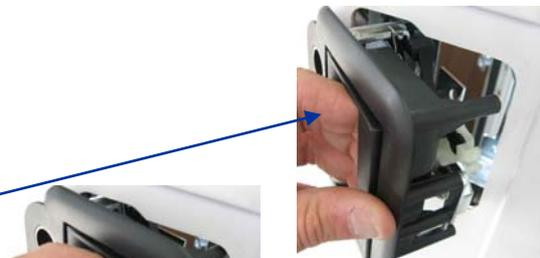
Faites passer le doigt de la poignée extérieure dans le U de la tringle de l'équerre droite.
