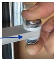
Reclipper le joint snap-on en commençant par l'angle à droit en haut de porte et en finissant en bas de porte au milieu.
