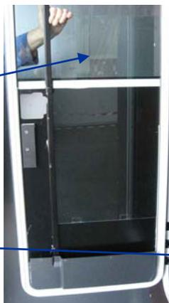
Mettre l'ensemble tôle sous le verre avec une cale.
