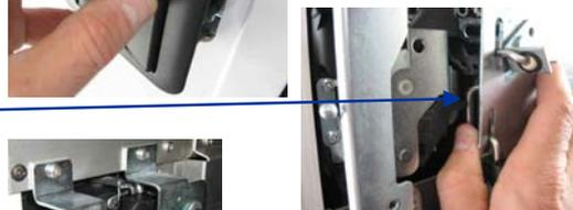
Ensuite orienter le doigt du cylindre du barillet dans le trou de l'équerre droite.
